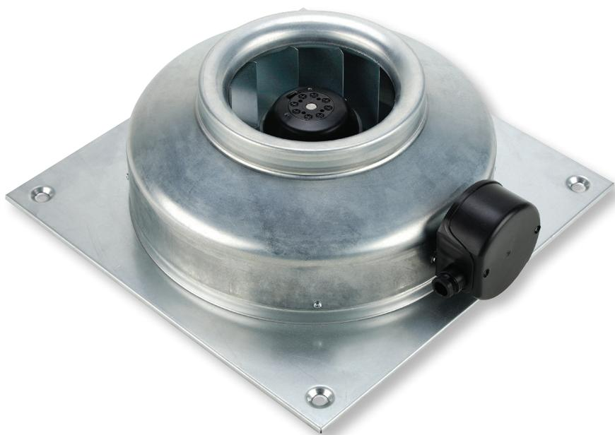
Вентиляторы для круглых каналов серии VENT-V предназначены для настенной установки. Вентиляторы изготавливаются из оцинкованной листовой стали и оснащаются электродвигателями с внешним ротором и рабочими колесами с загнутыми назад лопатками.
