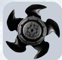
Серповидная форма лопастей обеспечивает **максимальный коэффициент полезного действия при минимальном уровне шума**. Динамическая балансировка соответствует требованиям ISO 1940. Крыльчатка изготовлена из оцинкованной стали.
